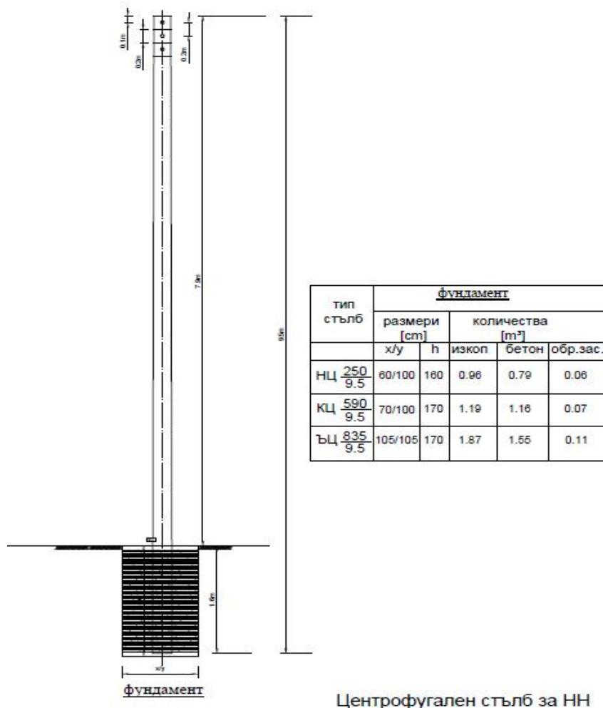
При изграждане на мрежата ще се използват стандартни стоманобетонни центрофугални стълбове тип СБС-250 (9,5м –носещ „НЦ“), СБС-590 (9,5м –краен „КЦ“), СБС-830 (9,5м –ъглов „YZ“ и стоманотръбни пилони .
