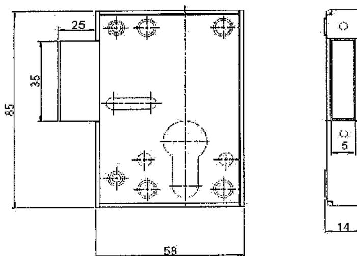
**3.6.** Брава за метална врата на трансформаторен пост – да осигурява тристранно заключване, оборудвана с ключалка и комплект лостове (приблизителни размери на вратата 2000 x 1000 мм, дебелина на ламарината до 2 мм).
