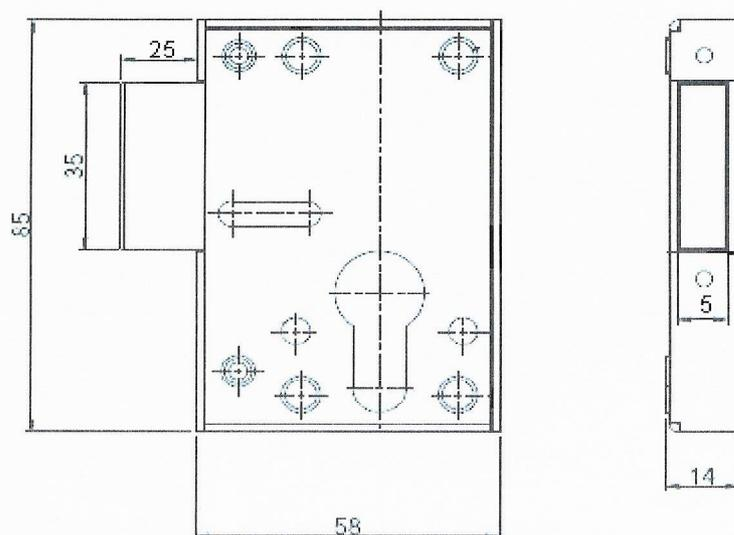
**3.6.** Брава за метална врата на трансформаторен пост – да осигурява тристранно заключване, оборудвана с ключалка и комплект лостове (приблизителни размери на вратата 2000 x 1000 мм, дебелина на ламарината до 2 мм).
