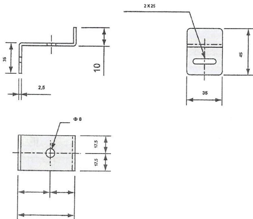
За монтаж на ТЕПО 1М се допускат различни от посоченото технически решения. Да са предназначени за стоманобетонни стълбове НН, стягане с неръждаема стоманена лента 20/0.4mm и закрепяне с болтове M8.
