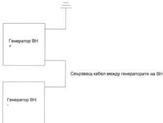
Схема: DC напрежение на междинната верига заземено от едната страна при положителния терминал
