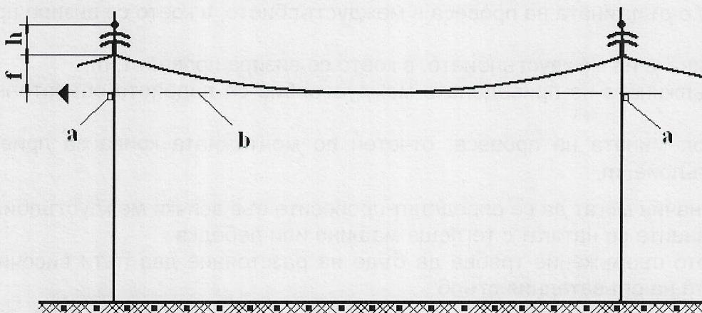
Определяне на провеса чрез визиране
