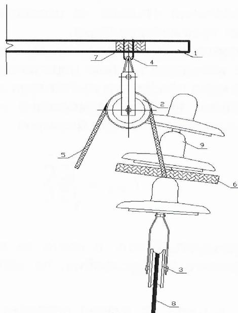
1 – конзола; 2, 3 – монтажни ролки; 4 - помощна скоба; 5 – стоманено въже; 6 – хамут за вдигане на изолаторна верига; 7 – дървено трупче; 8 - проводник; 9 – изолаторна верига
