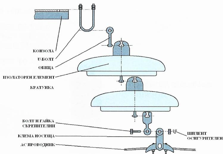
Тези вериги се използват при носещи стълбове тип НМГ. Проводникът от монтажните ролки се прехвърля на тях като се полагат в носещите клеми, които се монтират на долния край на изолаторната верига. Чрез U-образни притягащи клеми, проводникът се затяга към същинската клема.
