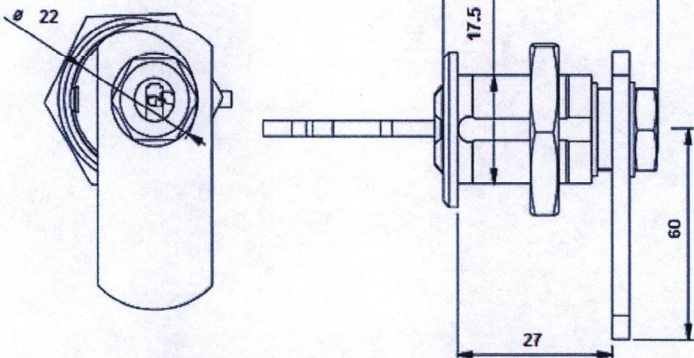
В комплекта да бъде включена метална планка с необходимите крепежни елементи за предотвратяване на превъртането на бравата в кръгъл отвор на **табло**.
