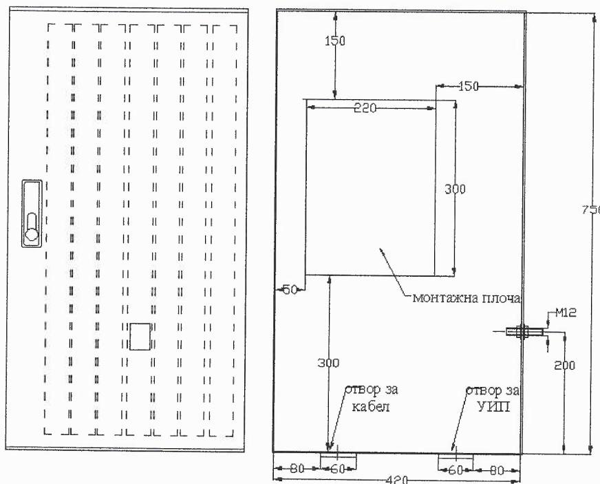
**Забележка:** Посочените размери са препоръчителни максимални. При доказване на функционалността след нормално присъединяване на входящите кабели и проводници, се допуска изделието да бъде изработено с намалени вътрешни разстояния.
