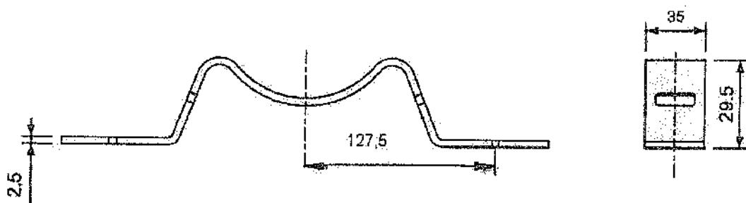
За монтаж се допускат различни от посоченото технически решения. Да са предназначени за стоманобетонни стълбове НН, стягане с неръждаема стоманена лента 20/0.4 mm и закрепяне с болтове M8 и разстояние между отворите по хоризонтала 255 mm.
