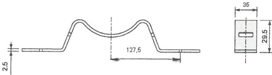
За монтаж се допускат различни от посоченото технически решения. Да са предназначени за стоманобетонни стълбове НН, стягане с неръждаема стоманена лента 20/0.4 mm и закрепяне с болтове M8 и разстояние между отворите по хоризонта 255 mm.
