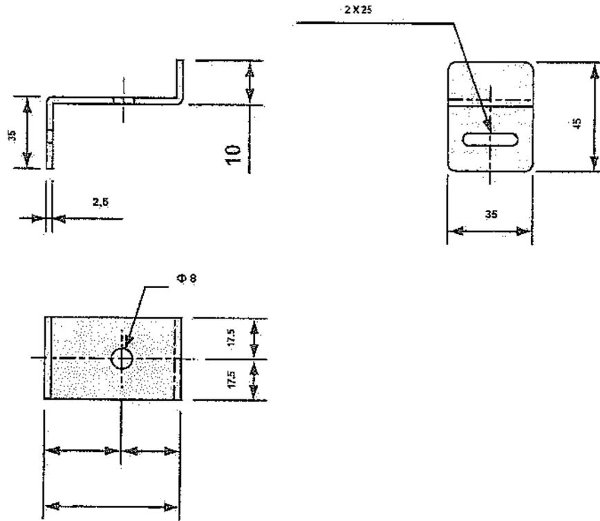
За монтаж на ТЕПО 1М се допускат различни от посоченото технически решения. Да са предназначени за стоманобетонни стълбове НН, стягане с неръждаема стоманена лента 20/0.4mm и закрепяне с болтове М8.
