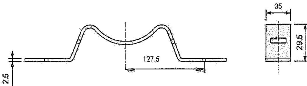
За монтаж се допускат различни от посоченото технически решения. Да са предназначени за стоманобетонни стълкове НН, стягане с неръждаема стоманена лента 20/0.4 mm и закрепяне с болтове M8 и разстояние между отворите по хоризонтала 255 mm.
