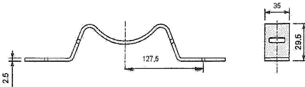
За монтаж се допускат различни от посоченото технически решения. Да са предназначени за стоманобетонни стъллове НН, стягане с неръждаема стоманена лента 20/0.4 mm и закрепяне с болтове M8 и разстояние между отворите по хоризонтала 255 mm.
