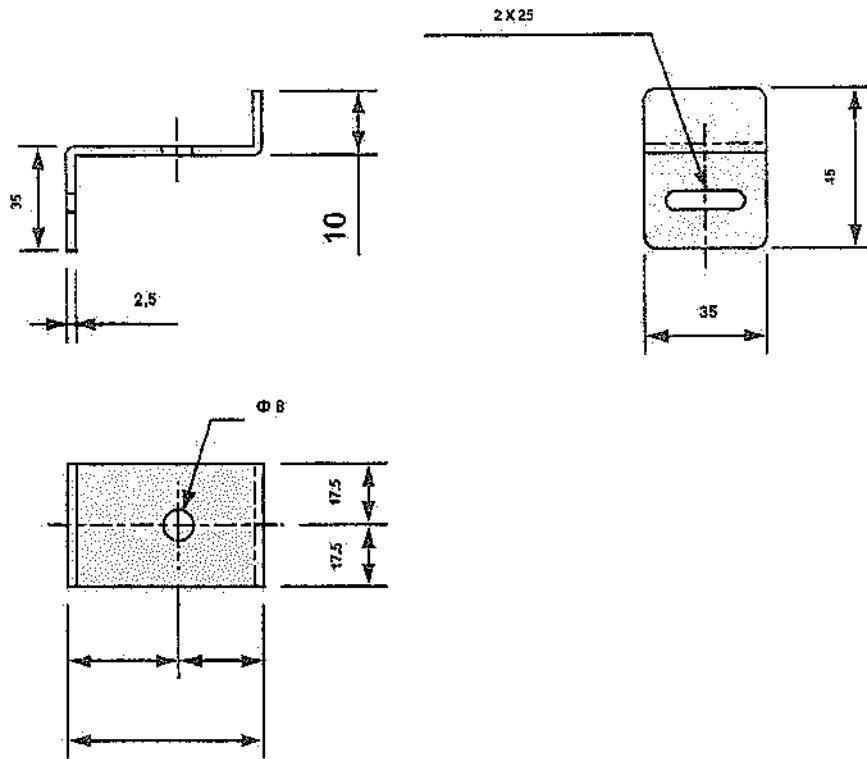
За монтаж на ТЕМО 1М се допускат различни от посоченото технически решения. Да са предназначени за стоманобетонни стъллове НН, стягане с неръждаема стоманена лента 20/0.4 mm и закрепяне с болтове M8.
