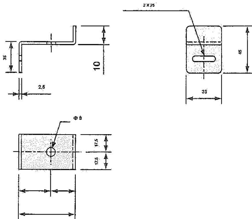
За монтаж на ТЕМО 1М се допускат различни от посоченото технически решения. Да са предназначени за стоманобетонни стълкове НН, стягане с неръждаема стоманена лента 20/0.4 mm и закрепяне с болтове M8.
