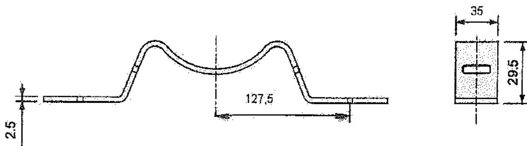
За монтаж се допускат различни от посоченото технически решения. Да са предназначени за стоманобетонни стълкове НН, стягане с неръждаема стоманена лента 20/0.4 mm и закрепяне с болтове M8 и разстояние между отворите по хоризонтала 255 mm.
